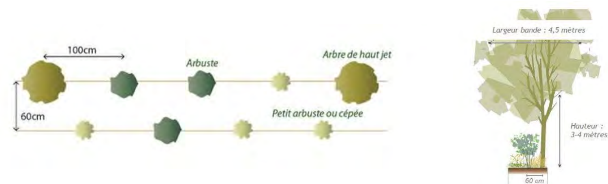
Figure 182. Schéma d'implantation et de structure d'une haie multistrate (source : BIOTOPE)
